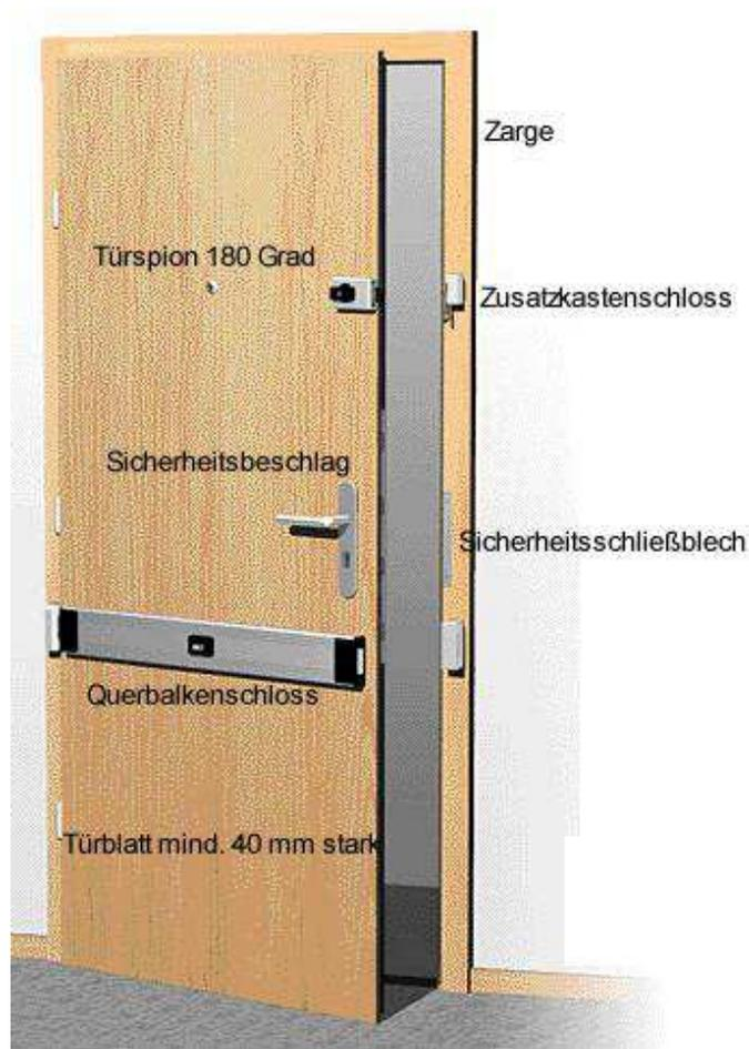
Bei Neu- oder Umbau wird der Einbau von geprüften, einbruchhemmenden Türelementen nach
